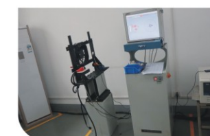
风机动平衡检测台
