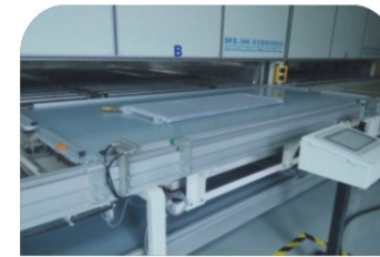
真空氮检流水线作业
