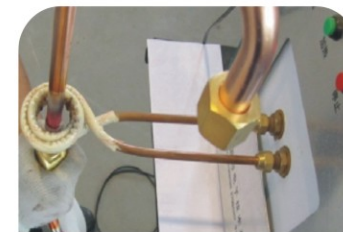
hf welding技术（高频焊接）
